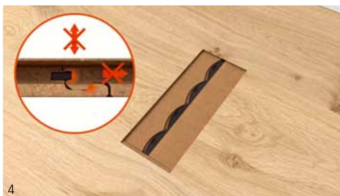
4 Tím se docílí spolehlivého a tvarově stabilního spoje pero-drážka.
